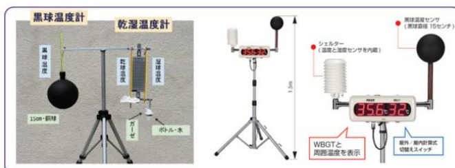
図 3-2 暑さ指数（WBGT）測定装置 左は基本型、右は電子式のもの（出典：環境省 19 ）
