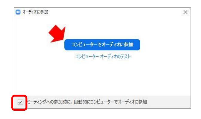
このとき、左下の「ミーティングへの参加時に、自動的にコンピューターでオーディオに参加」にチェックを付けておくと、次回から、このウィンドウは表示されなくなります。
