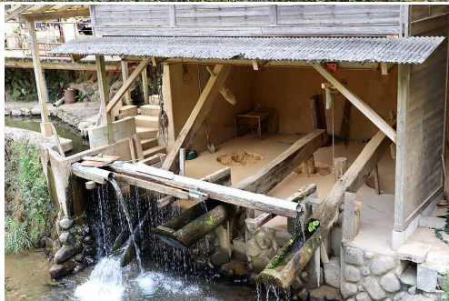
【上】乾燥を終えた原土は、水力を利用した唐臼で粉碎。20～30日ぐらいかけて粒子状にする。
