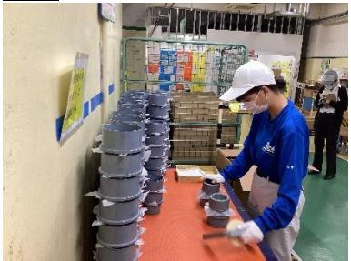
製造の仕事で大切なことは、作業手順を守り、品物が基準通りにできているか検査をし、出荷することです。左の写真は、衛生陶器を作る際に必要なアダプターの梱包作業を行っている様子です。①包装材を組み立てる②アダプター、説明書を入れる③テープで封閉じし、品番ラベルを貼り付ける④パレットに並べるなど一連の作業を指示通りにできました。製造の仕事は、ミスをしてしまうと大きな事故に繋がることもあり、怪我することもありますので、「正確さ」「丁寧さ」を意識して「安全」に仕事ができる力が求められます。
