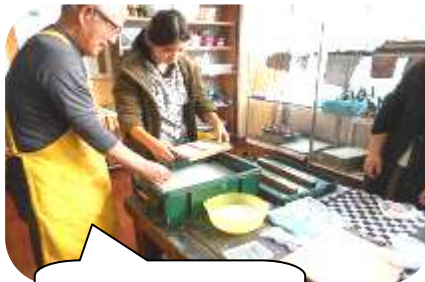
型枠にそっと、パルプを流し入れます。
